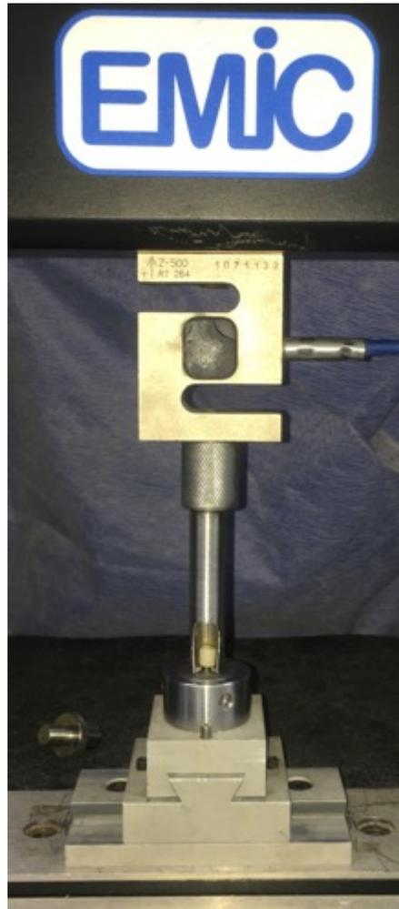
**Figura 1** - Estrutura de aço parafusada na célula de carga em sua porção superior. Na porção inferior, adapta-se à zona retentiva do coping de zircônia.
