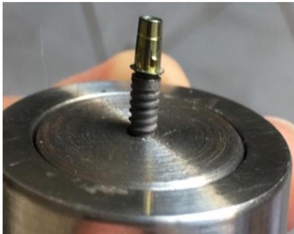
**Figura 8.** Implante sendo rosqueado na base de aço.
