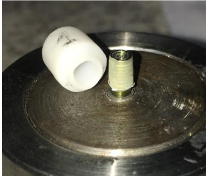
**Figura 4.** Coping de zircônia removido após o teste de tração. Notar o cimento de ionômero de vidro em volta do pilar TiBase, indicando uma falha adesiva
