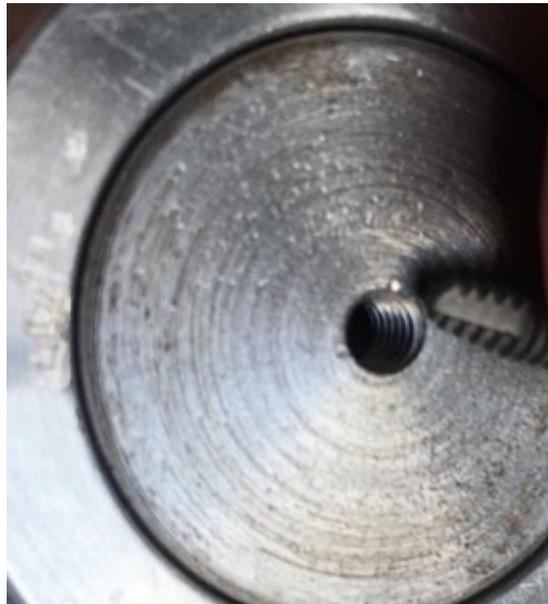
**Figura 7.** Base de aço para encaixe e aprisionamento do implante.
