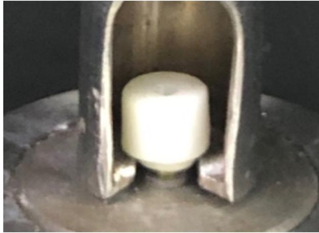
**Figura 6.** Dispositivo de tração adaptado no coping de zircônia.
