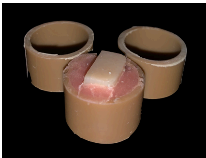
Figura 3 – Superfície cerâmica montada em anel de policloreto de vinila
