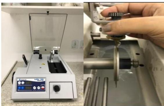
Figura 3 - máquina de precisão de corte Isomet
