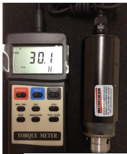
Figura- 3) Torquímetro digital TQ 680
