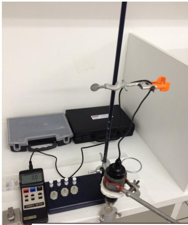
Figura- 2A) Sistema de aferição e registro do movimentos de torque e torque de remoção.
