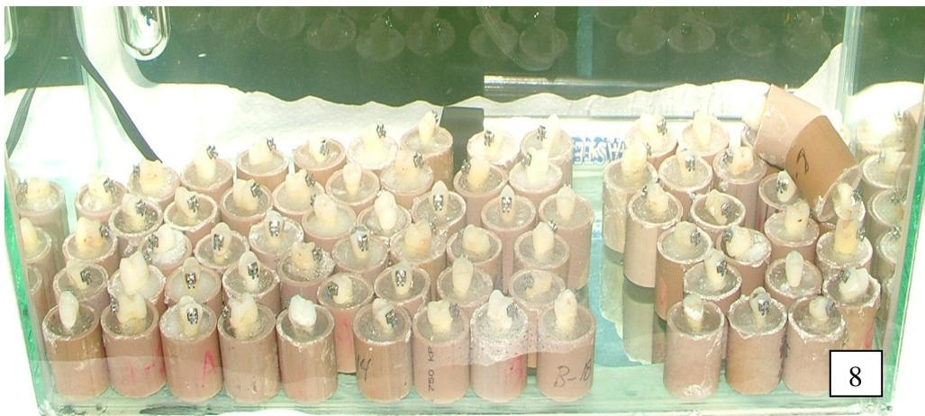
Figura 8: Corpos de prova armazenados em água destilada à 37°C.
