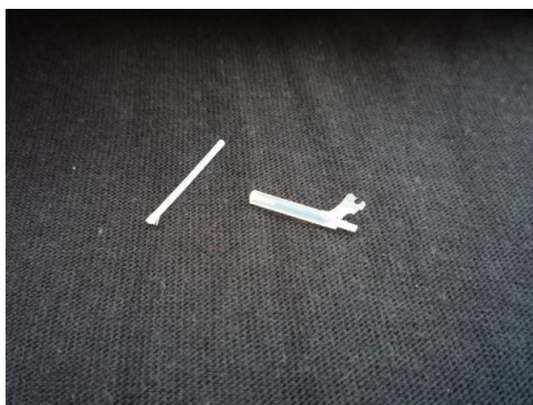
Figura – Segmento de fio FRP ASTICS, com e sem o revestimento de proteção.
