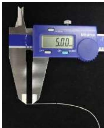
Figura 2: Aferição dos 5mm distais. Figura 3: Momento inicial do tratamento térmico
