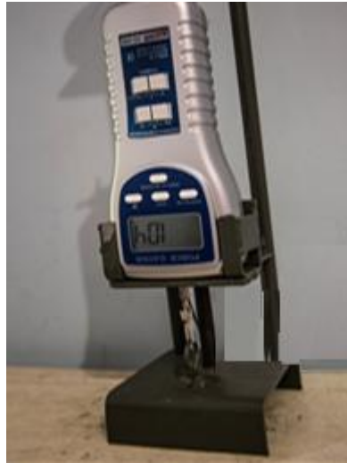
Figura 1. Dinamômetro DD 500 adaptado ao suporte metálico realizando teste de distensão. Figure 1. DD 500 dynamometer adapted to the metal support by performing stretching test.
