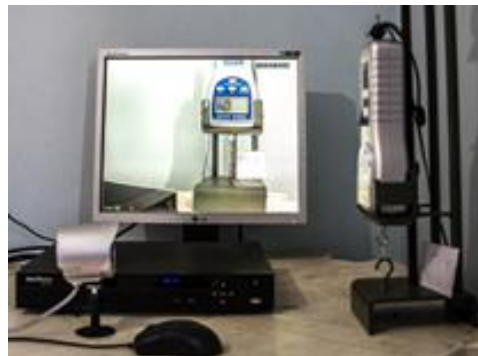
Figura 2. Imagem com parte dos recursos usados; câmera de infravermelho, monitor, dinamômetro, dispositivo adaptado, DVR, mouse. Figure 2. Image with part of the resources used ; infrared camera , monitor, dynamometer , adapted device , DVR, mouse.
