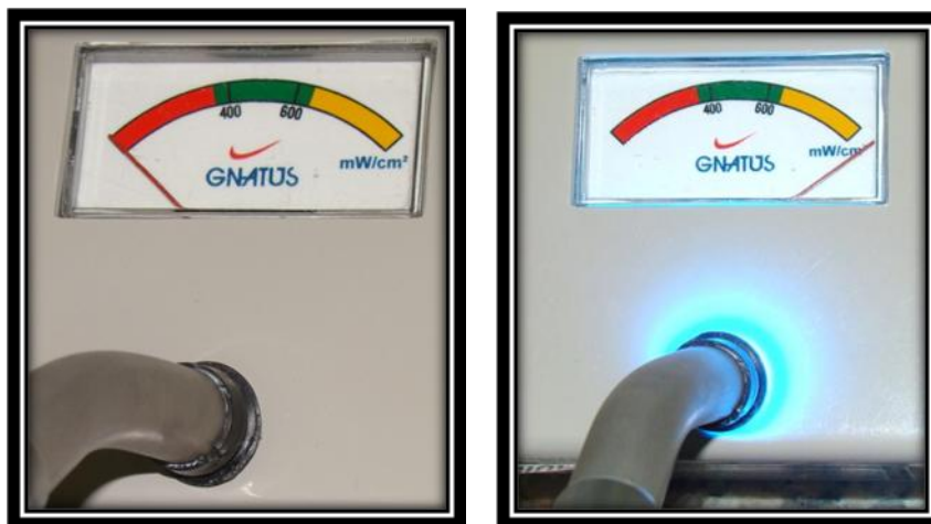
Figura 7: Medição da intensidade de luz do aparelho fotopolimerizador através de radiômetro.
