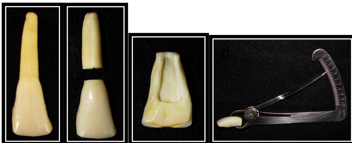
Figura 2: a) Dente bovino; b) Dente bovino seccionado; c) Dente bovino com abertura lingual; d) Medição da espessura da parede vestibular.
