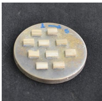
Figura 12: A secção de esmalte de cada grupo foi posicionada em um stub com o auxílio de uma fita de carbono condutora para serem levados a um aparelho metalizador.
