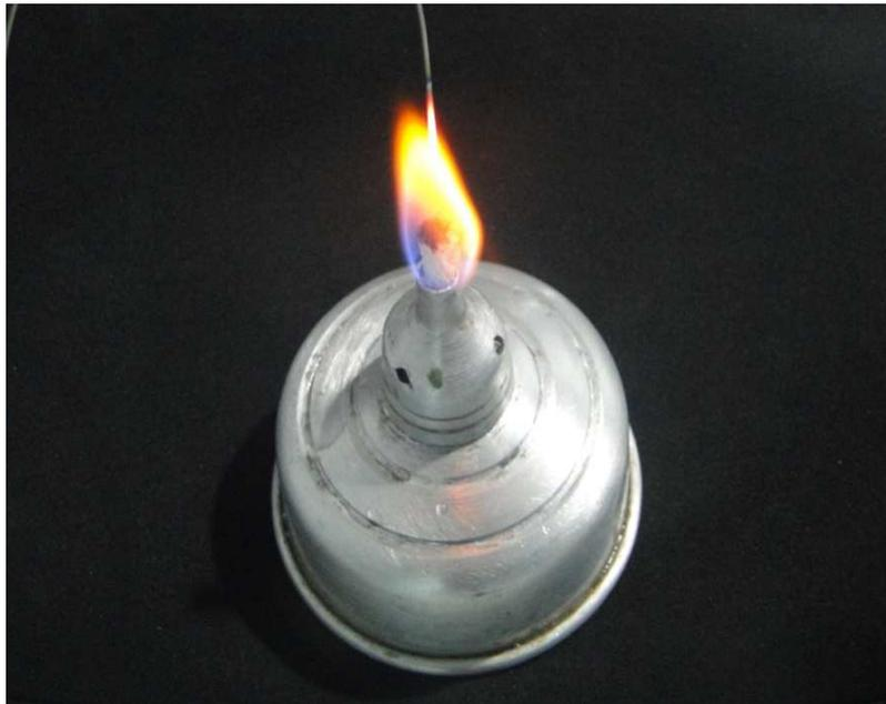
Figura 6 - Tratamento térmico, realizado no fio de níquel-titânio.
