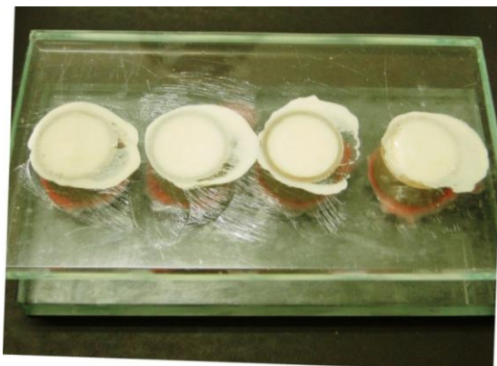
Figura 2: Placa de vidro sobre os corpos-de-prova durante a fase de polimerização da resina
