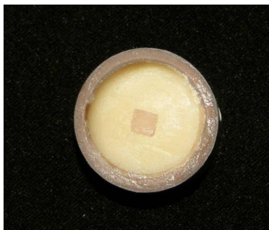
Figura 7: Corpo de prova após descolagem do acessório
