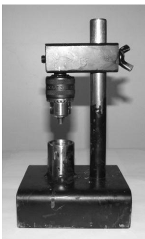
Figura 2: Dispositivo para padronização da fixação do mini-implante.
