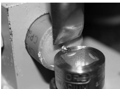
Figura 4: Posicionamento do corpo-de-prova na máquina de ensaios mecânicos.
