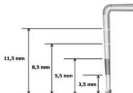
Figura 1: Sonda CPI, ilustrando as marcações com as distâncias, em milímetros, à ponta da sonda. Fonte: Brasil (2011)
