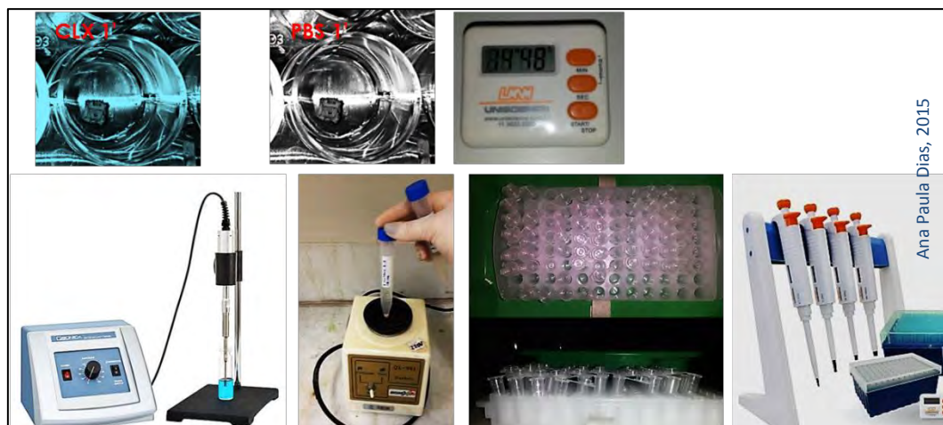
Fig.18 – detalhes da solubilização do biofilme e Eppendorfs usados na diluição seriada.
