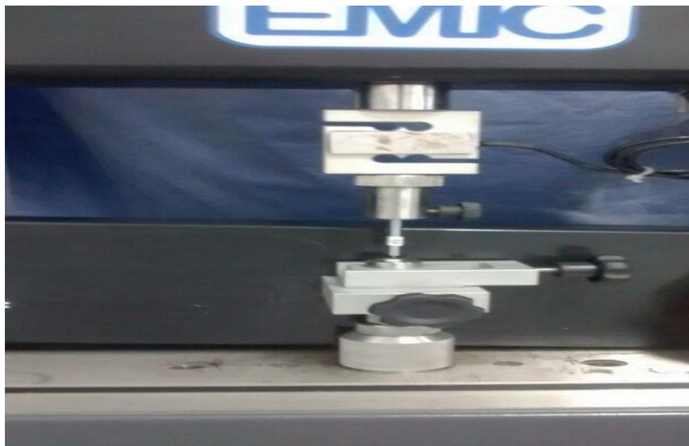
Fig. 08 Teste de push-out na máquina de ensaio universal (EMIC).
