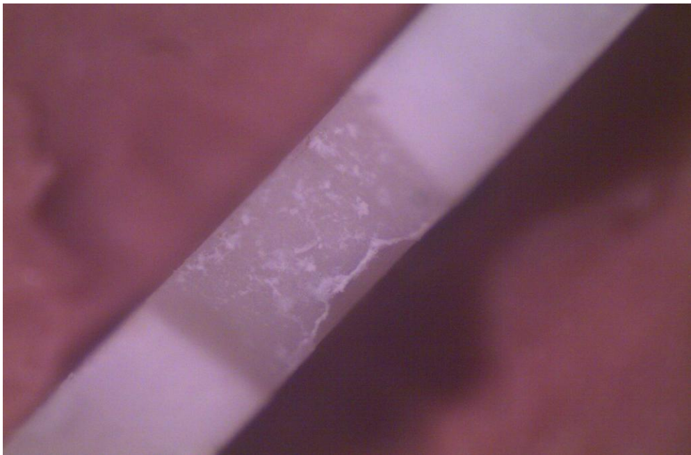
Fig. 14 Fratura adesiva entre cimento resinoso e pino do grupo convencional.
