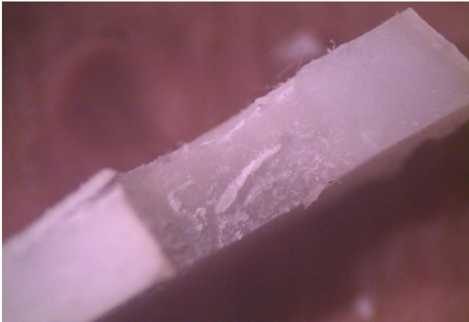
Fig. 13 Fratura adesiva entre cimento resinoso e pino do grupo anatomizado.
