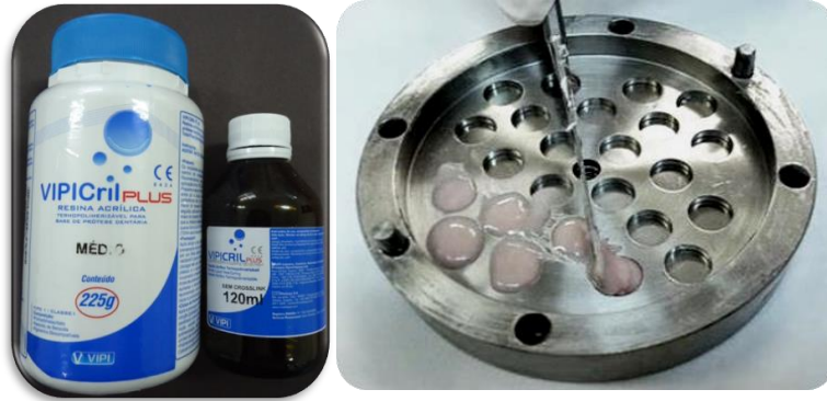
Figura 6. (A) Resina acrílica termo-polimerizável utilizada e (B) inserção da resina manipulada na matriz de inox para confecção dos discos.
