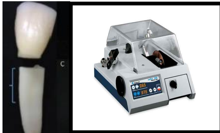
Figure 3. Dentes seccionados abaixo da junção cimento-esmalte (CEJ) com o auxílio de um disco diamantado em baixa rotação - Isomet.
