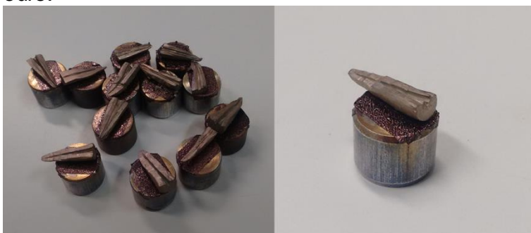
Figura 15. Espécimes fixados em Stubs metálicos e revestidos de ouro.
