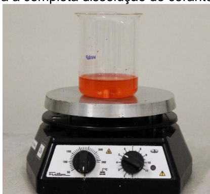
Figura 5. Após a junção dos elementos, o béquer foi colocado no agitador magnético para a completa dissolução do corante.
