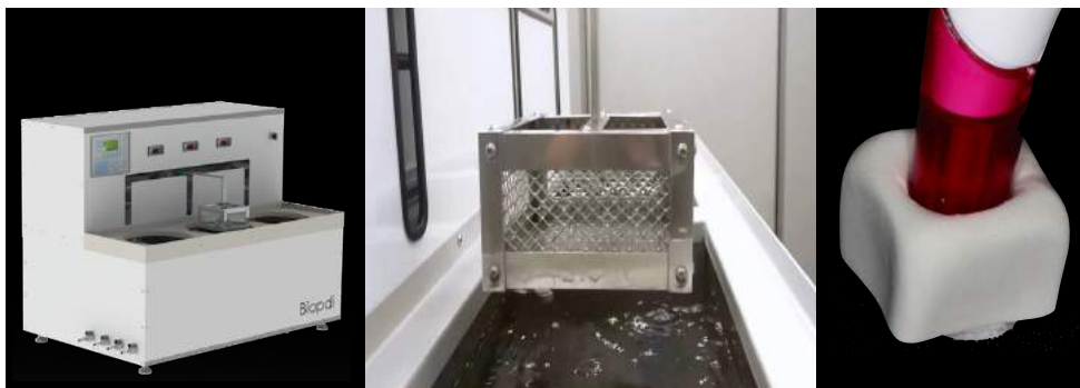
Figura 10 - Inserção do conjunto resina/cimento/disco de cerâmica à termociclagem (20.000 ciclos) e mensuração de cor ( \Delta E5 ).
