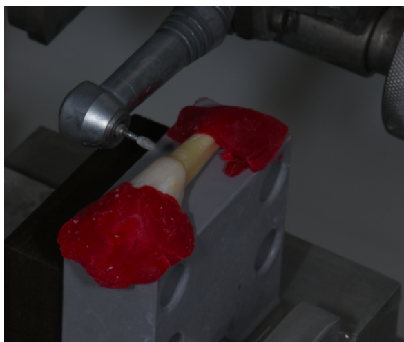
Fig. 7 – Preparo das cavidades cervicais em aparelho padronizador
