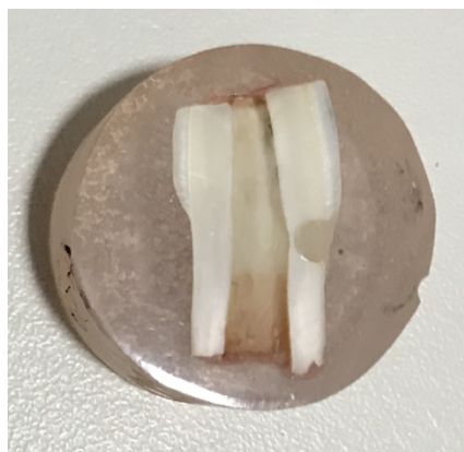
Fig. 8 – Amostras seccionadas, incluídas e lixadas para o teste de dureza
