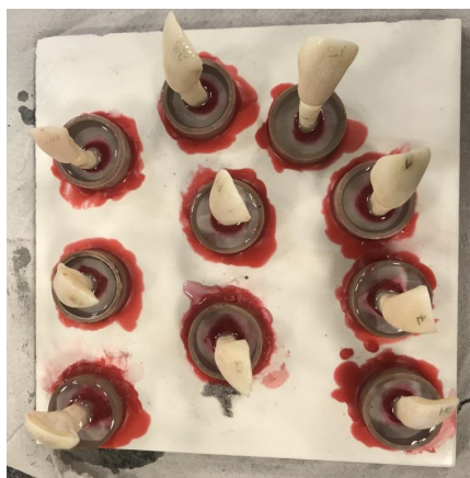
Fig. 6 – Dentes embutidos em resina de poliestireno
