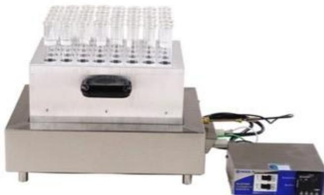
**Figura 10.** Mesa de bloco digestor digital microprocessado com sistema PID utilizado para aquecimento da amostra experimental na temperatura de 90°C por 4 horas
