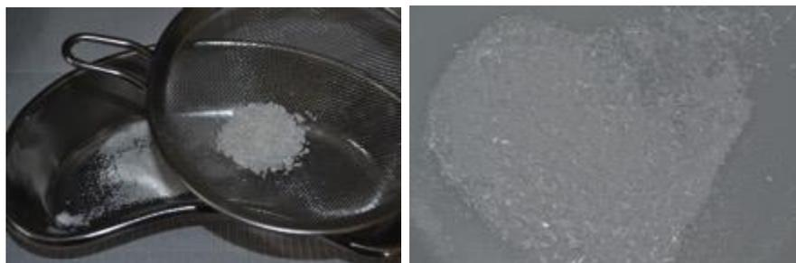
**Figura 7 e 8.** Passagem em peneira de aço inox após trituração das conchas, para padronização do tamanho das partículas
