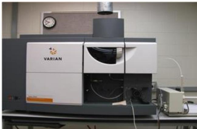
**Figura 11.** Aparelho utilizado para determinar o teor dos minerais da amostra experimental
