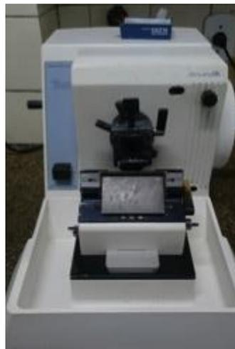
**Figuras 30.** Aparelho micrótomo utilizado para os cortes histológicos de 4  $\mu\text{m}$  de espessura
