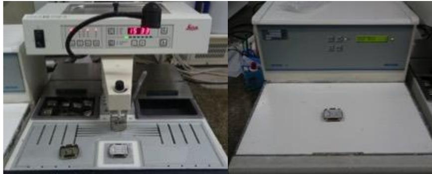
**Figuras 28 e 29.** Aparelho para inclusão das peças em parafina aquecida seguido de resfriamento em prancha fria
