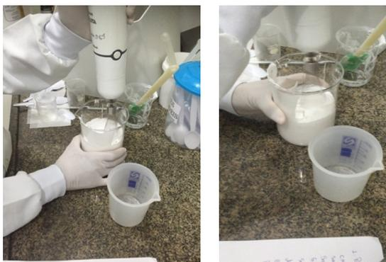
**Figura 9.** Agitador mecânico incorporando a fase 1 e 2.
